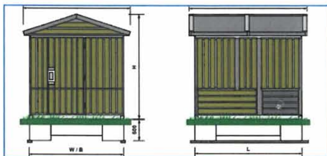
Nettstasjon ABB Magnum
