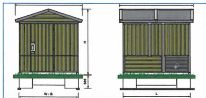
Nettstasjon ABB Magnum
